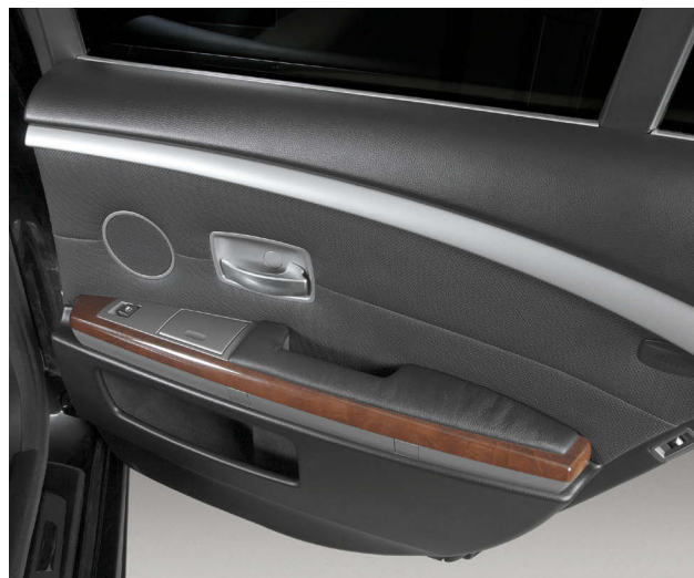
Часть тыловой акустики установлена в задних дверях, часть — на задней полке
