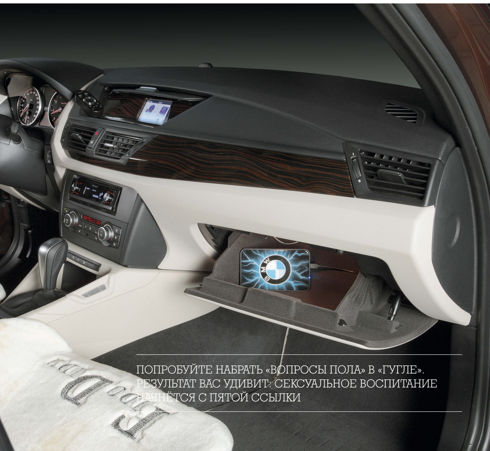
Отобранные лично руководителем Etop пищалки стоят в подиумах, повторяющих контуры штатной сетки
